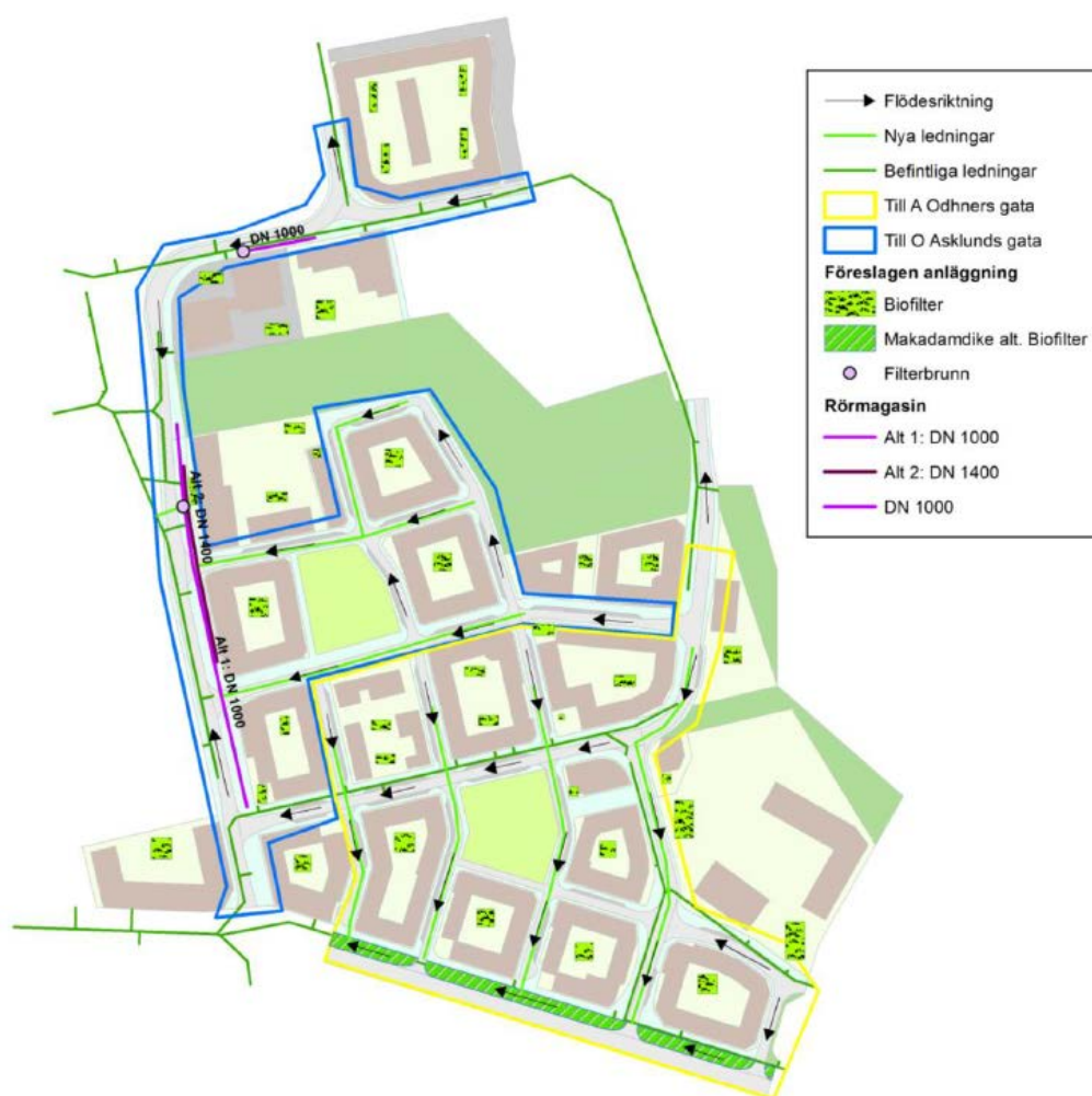
Figur 23. Översiktlig illustration av föreslagna dagvattenanläggningar, ytavrinningsvägar och anslutningar till befintligt ledningsnät. Blått område visar område som avvattnas till rörmagasin längs med Olof Asklungs gata, medan gult område visar område som avvattnas till trädstråk med skelettjord längs med A Odhners gata. Nya ledningar har föreslagits och ritats in specifikt för
